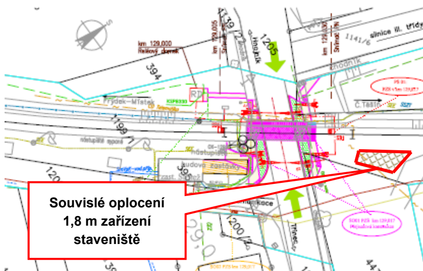
Obrázek 3: Oplocení staveniště včetně umístění zařízení staveniště
